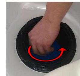
4. Drehen Sie den Papierfilter gegen den Uhrzeigersinn.
