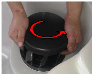
1. Drehen Sie das Schutzgitter gegen den Uhrzeigersinn.
